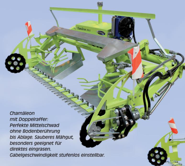
Chamäleon mit Doppelraffer: Perfekte Mittelschwad ohne Bodenberührung bis Ablage. Sauberes Mähgut, besonders geeignet für direktes eingrasen. Gabelgeschwindigkeit stufenlos einstellbar.
